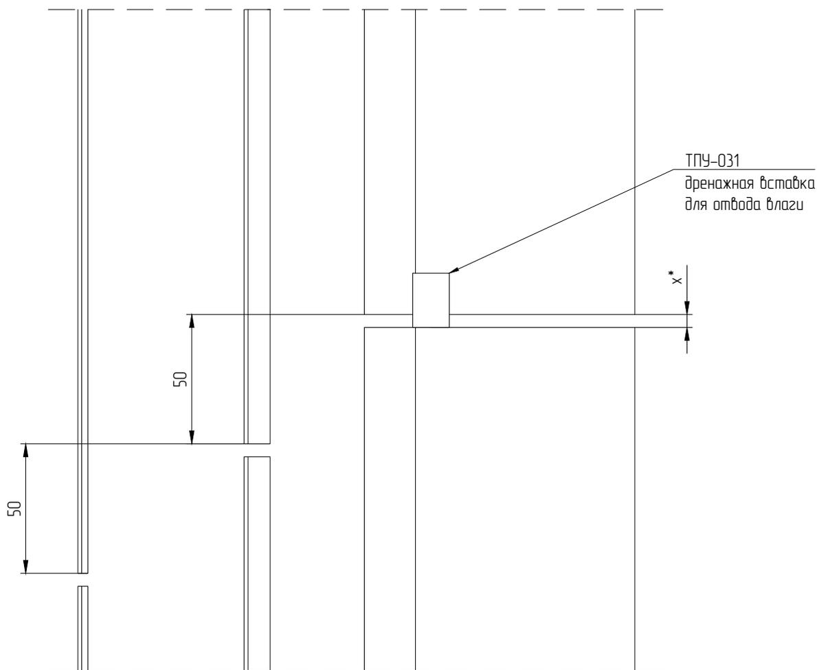
x – допустимый зазор между стойками не менее 1 мм на 1 м длины стойки.
